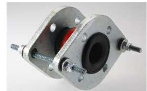
Gummikompensator mit losen Flanschen und geräuschkämmend gelagerter Außenverspannung, für laterale Bewegungsaufnahme oder zum Abbau von Schwingungen.
